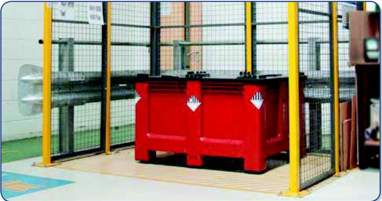
Exemple d'endroit bien protégé, avec une cage assurant la protection contre les chocs accidentels, les batteries étant logées dans un conteneur assurant une protection contre la chaleur, les chocs et les déversements accidentels de liquides.
